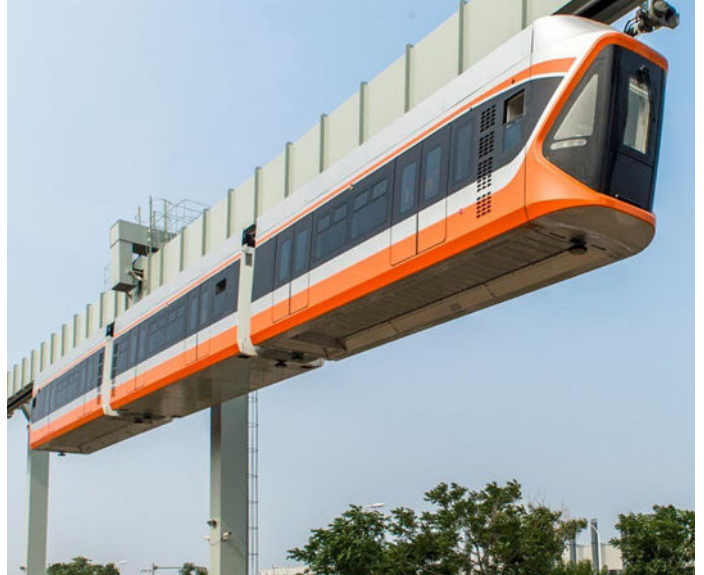
Görsel 4.2.1: Havada asılı hareket edebilen skyTrain
